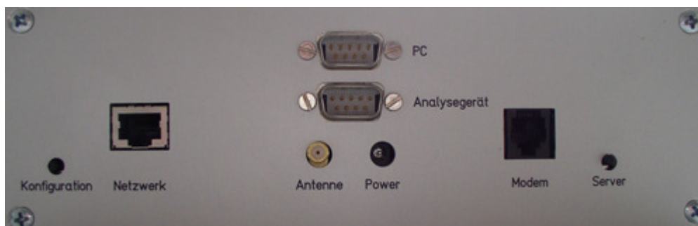
Abb. 5.23 Die Rückseite des entwickelten Telematik-Moduls
